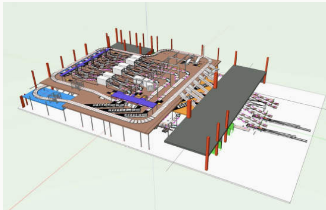
取合い検討モデル ・ 構造体内に納めた仕分け機 ・ 設置後の仕分け設備
