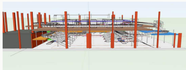
取合い検討モデル・構造グリッドに対するコンベヤ支持
